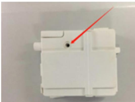
1.3 Inserte el módulo WiFi como se muestra en la figura (El "Kit inteligente" está marcado boca arriba)
